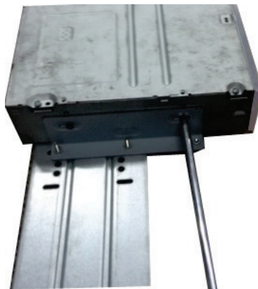
⑥ 用螺丝刀拧紧螺丝
