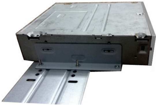
⑤ 安装 SATA 刻录机，将 SATA 刻录机对准孔位
