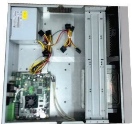
⑤ 安装 SATA 刻录机，将 SATA 刻录机对准孔位
