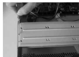
⑥装上硬盘上支架，予以固定，用同样的方法将硬盘固定在上硬盘支架上
