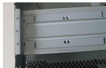
③拆卸硬盘上支架后，可看到硬盘下支架
