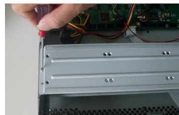
⑥装上硬盘上支架，予以固定，用同样的方法将硬盘固定在上硬盘支架上
