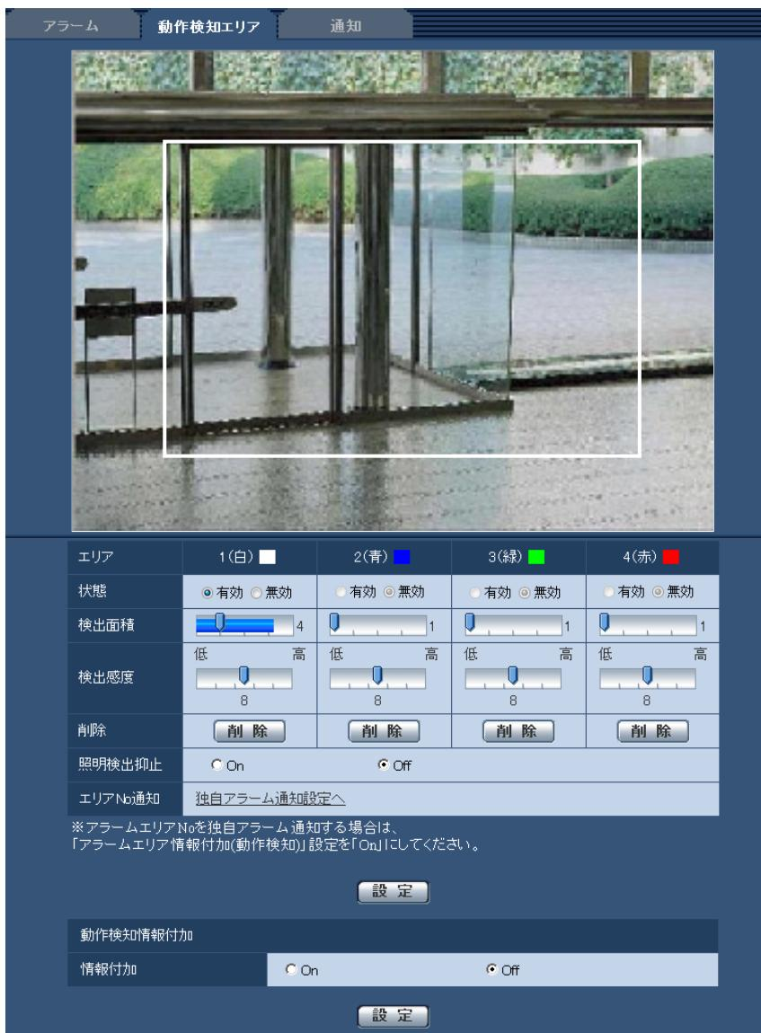
**2** 「検出面積」「検出感度」をスライダーバーで設定します。「検出面積」は、左端から中央までを使用します。「検出感度」は、左端から右端までを使用します。「検出面積」「検出感度」については、133 ページをお読みください。
