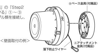
(5) 天井または壁に固定したワイヤー取付金 具に落下防止ワイヤーの先端についてい るスナップフックを引っ掛ける。
