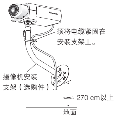
<装在墙壁上的安装示例>
