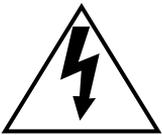
在正三角形中带箭头的闪电符号，用以提醒用户在本产品附近出现较大的非绝缘“危险电压”足以使人体产生触电。
